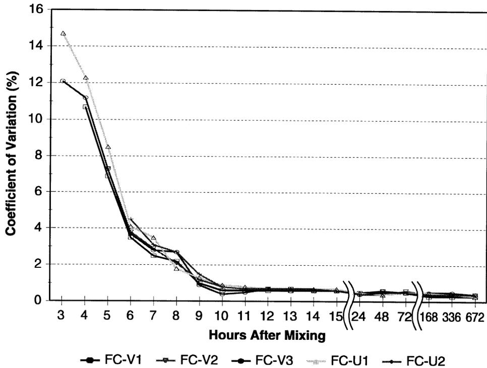
FIGURE 21. COEFFICIENT OF VARIATION VERSUS TIME FOR FIVE CONCRETE SAMPLES
