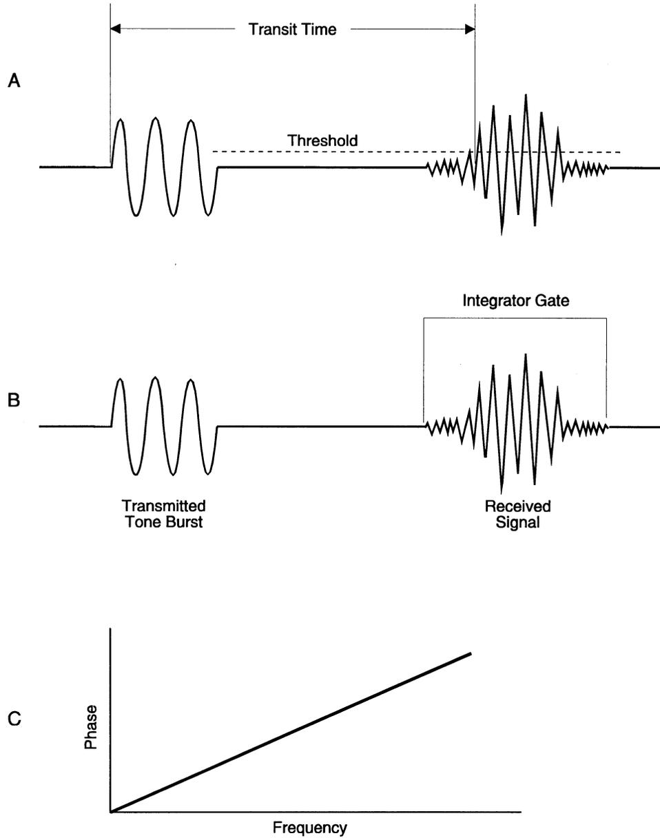
**FIGURE 4. TRANSIT TIME MEASUREMENTS**
