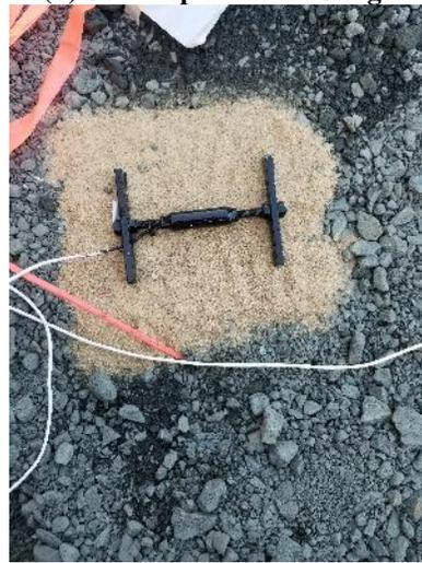
(d) Asphalt Strain Gauge
