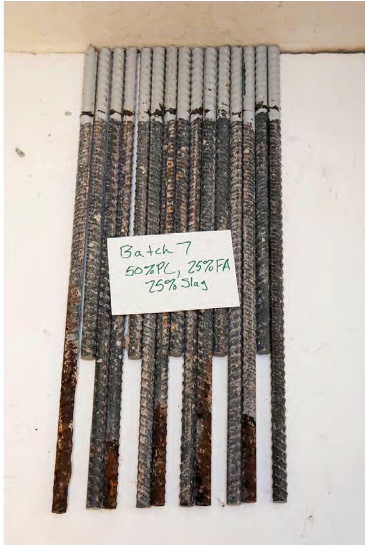
**Figure 21. VCTIR FA 25% + Slag 25% Mix Design**
