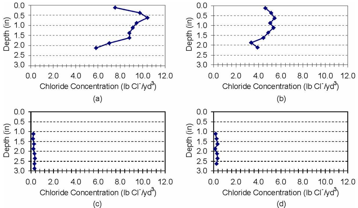
Figure 21. Acid-Soluble Chloride Concentration Profiles for Samples (a) A-7, (b) A-8, (c) B-1, and (d) B-4
